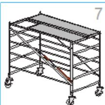
7- Colocar diagonal horizontal mediante bridas : de la pata del marco 1 en diagonal a la pata del marco 2, a la altura del segundo travesaño inferior.
