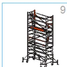
9- Seguir el montaje hacia arriba. En cada módulo colocar dos marcos, 2 diagonales verticales, 8 tirantes, 1 diagonal horizontal con bridas, 1 pasarela de escalera, 1 pasarela ciega y 1 escalera.
