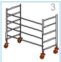
3- Calzar las 4 patas de los marcos con las ruedas y ajustarlas con la fijación mecánica.
