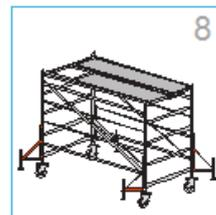
8- Colocar los estabilizadores . Uno en cada pata de marco de base, en línea con el perfil del marco. Sujetar mediante bridas. Regular el pie base hasta que este toque el suelo.
