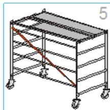
5- Ajustar la diagonal vertical en el lado interno: Anclaje tirante inferior marco 1, a anclaje tirante superior marco 2.
