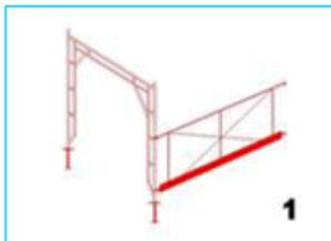
1.- Colocar un **pie base** en cada pata de un marco cerrado o **paso peatonal**, y una **baranda con zócalo**, ajustándola mediante los pivotes a los marcos o pasos peatonales.
