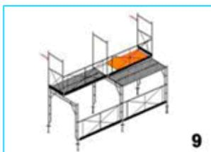
10.- Anclar el útil de montaje que protege al operario al subir cada planta. Seguir el montaje colocando por este orden: **pasarelas**, **marcos**, **barandas**, **barandas laterales**, y el **sistema de arriostramiento** en cada planta hasta alcanzar la cota deseada.
