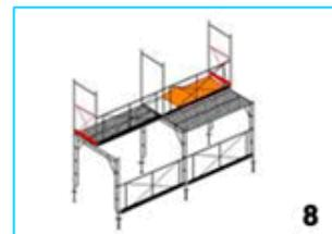
8.- Montar las **barandas laterales** de protección. Solo se colocaran en los módulos terminales y en todas las plantas a partir de la primera.
