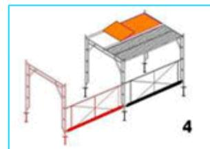
4.- Montar los siguientes módulos, empezando con **paso peatonal** o marco y **baranda**. Nivelar cada módulo montado.
