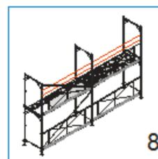
8- Montamos los **tirantes**, dos por módulo, desde la primera hasta la última planta que montemos. Se colocan sujetándolos mediante los pivotes internos del marco.
